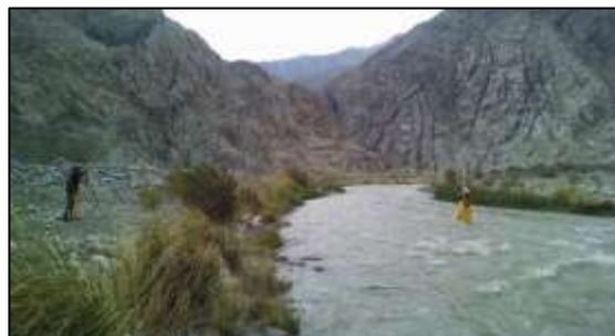
Se realizó un levantamiento topográfico de los 6 puntos de monitoreo de caudales, definidos en forma conjunta entre la Junta de Vigilancia del río Elqui y sus Afluentes y el equipo del proyecto SIMCA. Asimismo se realizaron aforos (medición del caudal en cauces) en cada uno de los puntos de monitoreo seleccionados para la cuenca. Esta actividad forma parte de la definición de los criterios para la implementación de una nueva red de monitoreo de caudales en la cuenca.
